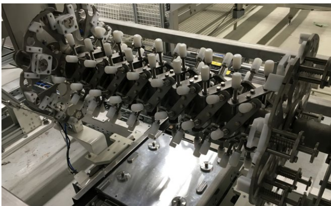
Vollautomatisierte Spezial-Trommel für Einzelteilaufnahme mit Greifer
